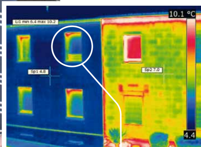
Besonders am gut isolierten Haus ist deutlich zu sehen, wie der Rollladen (hier blau) die Isolationseigenschaften des Fensters (grün) optimiert. Auffällig ist allerdings, wie am Rollladenkasten im oberen Sturzkasten-Fensterbereich Wärme verloren geht.
