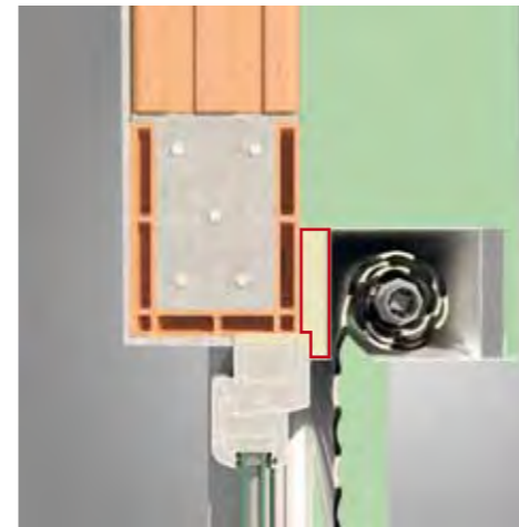
Möglichkeit 3: Proterma PLUS. Erhöhte Energieeffizienz durch rückseitige Kasten- und Führungsschienendämmung, Beispiel Putzmauerwerk/WDVS.
